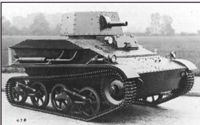
Een beproevingsmodel van de Lichte Tank Mark IV. Dit voertuig heeft een niet-standaard toren met een luchtgekoeld machinegeweer.
