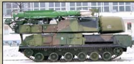
▲ Een Finse Buk M1 met rechts aan het draaiplatform, duidelijk zichtbaar de 9S35 Fire Dome.
